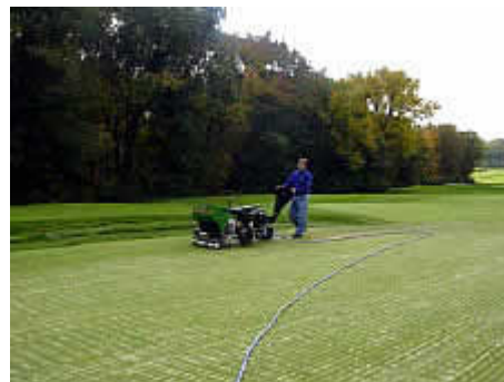
7:45 Faltam 4 passagens e o Objectivo é alcançável. 800kg de areia já estão injectados. A Dryject ao mesmo tempo que descompacta o solo também dilui o Thatch através do topdressing.
